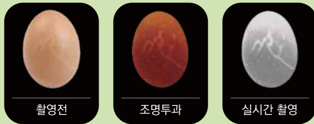
조명이 투과 된 계란을 흑백으로 촬영하는 것으로 보다 정확하게 계란의 이상 상태를 확인 할 수 있음
