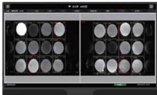
머신비전 계란품질검사 시스템 영상촬영 방식으로 계란 손상 위험 제로
